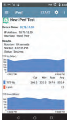
使用 TCP 或 UDP 幀進行 iPerf 輸送量測試
