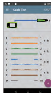
使用 Wiremap 進行線纜測試以檢測與故障點之間的距離（包括線纜遮罩層）
