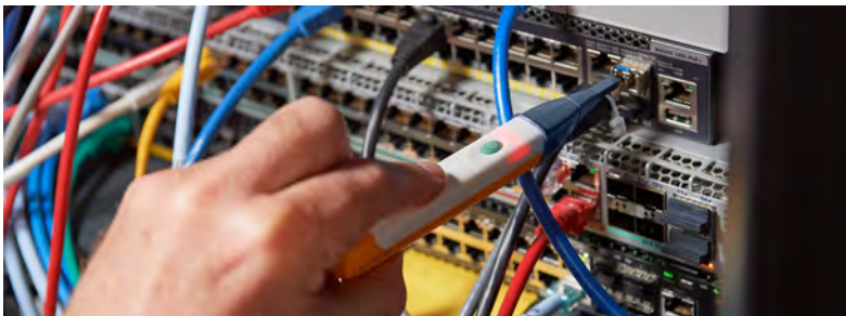
檢測光收發器是否正常工作。FiberLert™ 可在無接觸的狀況下檢測光源
