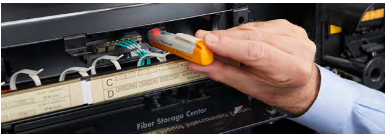
小巧尺寸便於穿過狹窄的配線架並檢測光纖Port是否存在光源
