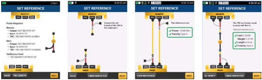
「基準參考設定精靈」簡化了設定流程並大幅減少錯誤。 左側圖示：顯示所選測試項目所需的所有配件清單。 中左圖示：精靈會顯示操作步驟，並驗證每項步驟是否已執行。 中右圖示：CertiFiber Max OLTS 針對所有 MPO 12/16/24 及 MMC 16/24 (有針及無針) 電纜，皆提供符合標準的「一跳線基準設定」(1-jumper reference)。 右側圖示：系統會檢查基準參考值是否合規，並將其儲存，作為設定正確的證明。 基準設定的結果 (包括每條受測光纖的測量功率，以及驗證跳線的損耗值) 都會被儲存，並隨專案測試報告一同呈現，為測試流程的正確性提供有力證據。
