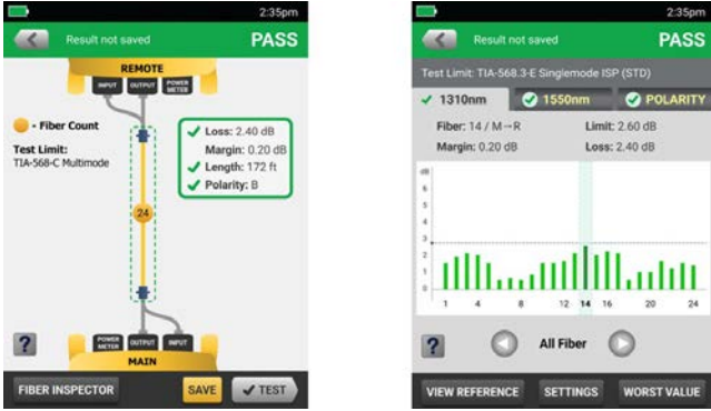
左圖：結果螢幕顯示「合格 (PASS)」或「不合格 (FAIL)」的判定結果，並列出最差損耗餘裕 (worst margin)、長度、極性、受測光纖總數以及測試限制值。 右圖：點擊受測光纖 (在此範例中標示為「24」) 即可開啟詳細結果，查看各條光纖在不同波長下的數據以及極性的詳細配置。
